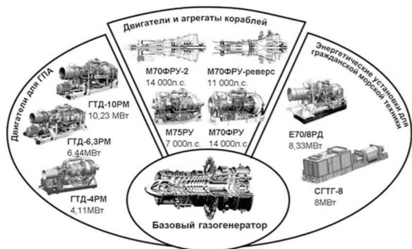
Семейство морских и промышленных ГТД ПАО «ОДК «Сатурн» на базе унифицированного газогенератора
